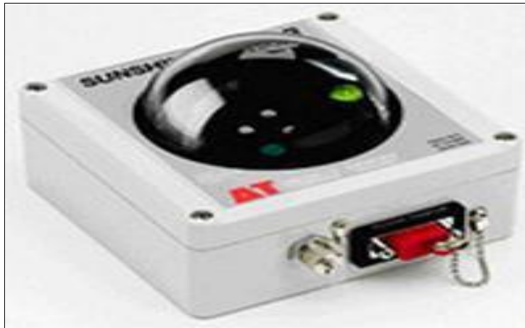
الشكل (٢) جهاز ماسح السطوع الشمسي
